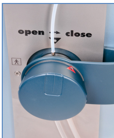
Fig. 4-19: Fixer l'obturateur de verrouillage
