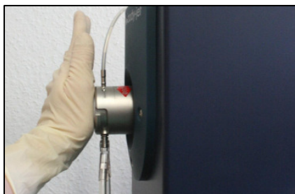
Fig. 23: Verrouiller la pompe d'infiltration
