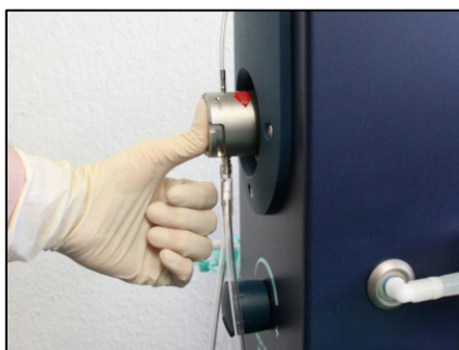
Fig. 24: Enclencher la pompe d'infiltration
