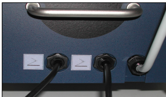
Fig. 11: Branchements des soufflets à pédale à la face arrière de l'appareil
