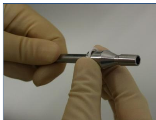
Fig. 3.5: Enlever le joint d'étanchéité
